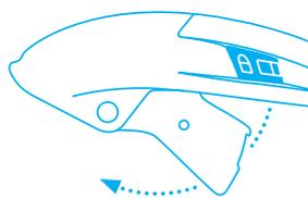
Danach drehen Sie den **Hebel aus dem Griff** heraus und öffnen Sie die Klingendeckung.
